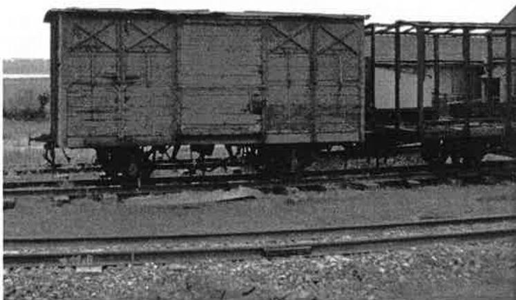
Un couvert en bois sur le faisceau de garage du dépôt. A droite, châssis et structure attendent un nouvel habillage en bois (photo Jean-Claude Botspoel).
