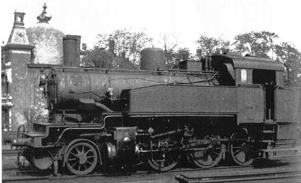
Locomotive type 93, 9386 photographée à Antwerpen en 1930 alors qu'elle n'était pas encore munie de marchepieds sur la soute arrière. (Photo collection Phil Dambly)
