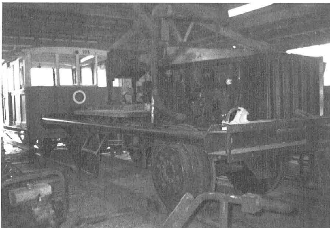
Dans la remise, à l'avant-plan une draisine déshabillée où ne subsiste que le châssis supportant le moteur et l'échappement. Juste derrière celui-ci, le siège conducteur. Remarquons l'utilisation des roues Michelin avec pneu. Cet engin est conçu pour la voie métrique (photo Liliane Braibant).
